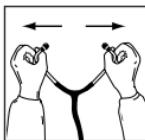
Para reduzir a tensão da mola nas hastes, separe-as uma pra cada lado. Repita o processo até alcançar a tensão desejada.
