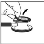
Para remover a membrana adaptável Littmann, aperte a borda da membrana com as unhas do polegar e indicador; puxe e levante a membrana da campânula.
