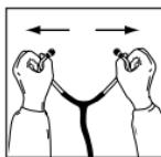
Per ridurre la tensione della molla nell'auricolare, tirare i tubicini auricolari in modo da allontanarli. Ripetere l'operazione fino a ottenere la tensione desiderata.
