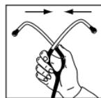
要增加耳塞中耳件簧张紧度，请挤压耳管。重复此操作直至松紧度合适。
