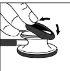
Per montare la ghiera antifreddo, posizionare un lato della ghiera sul bordo della testina ed estendere la ghiera sopra e attorno al bordo della testina.
