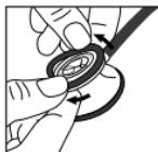
要想重新安裝 Littmann 可調音懸浮振膜，則先將防寒圈移除。將可調音懸浮振膜的柔軟邊緣插入邊緣的溝槽內，慢慢旋轉邊緣將其安裝到聽頭邊緣。
