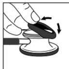
For at montere klokvens kuldefri gummiring, placer den ene side af gummiringen på kanten af bryststykket og stræk den over og rundt om bryststykrets kant.
