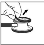
Om het instelbare Littmann-membraan te verwijderen, plaatst u de nagels van uw duim en wijsvinger in de rand van het membraan. Trek vervolgens aan het membraan om het van het borststuk af te halen.
