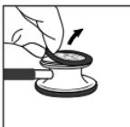
要想移除 Littmann 悬浮式可调振动膜，用拇指和食指捏住可调振动膜边缘；从听诊头上将可调振动膜向上拉出。
