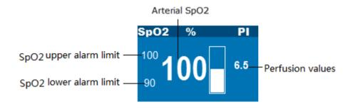
Figure 10-1: SpO<sub>2</sub> parameter display
