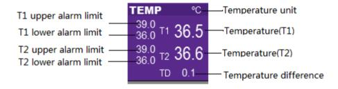
Figure 12-1: TEMP parameter display
